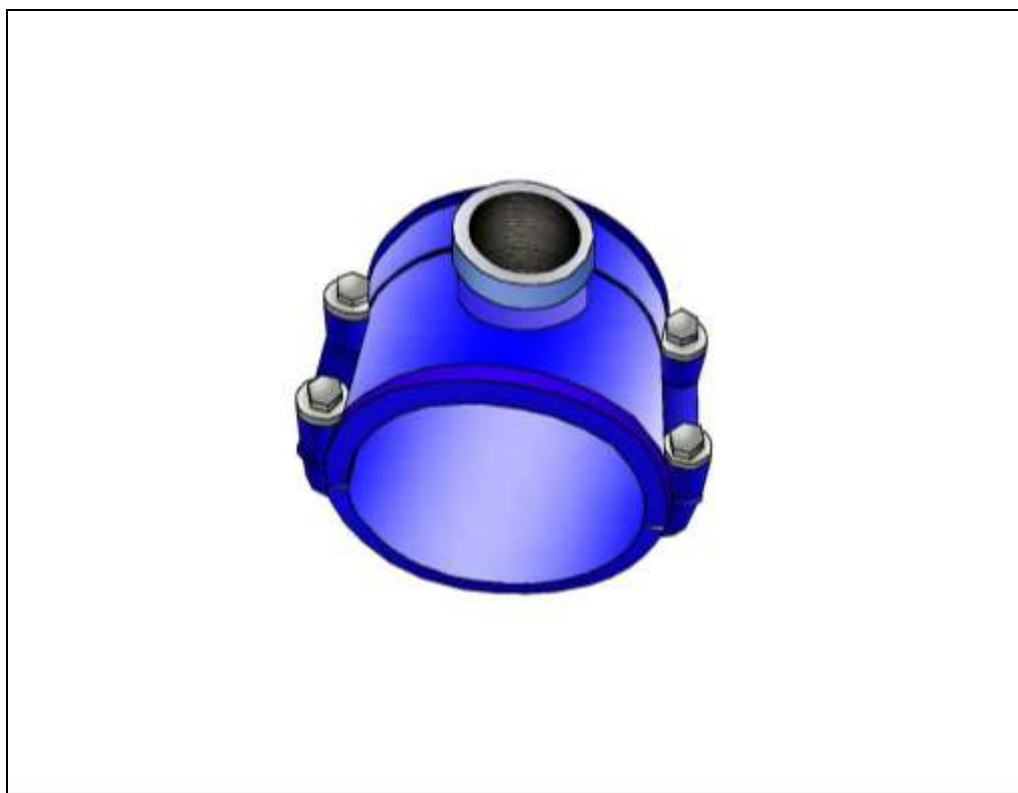
Σχήμα 2. Τυπικός σύνδεσμος - σέλλα υδροληψίας από ελατό χυτοσίδηρο GGG 50, με θηλυκό σπείρωμα και under part
